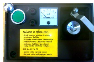
Obrázok 68. Meracia súprava a prípravok na meranie kinematickej viskozity
