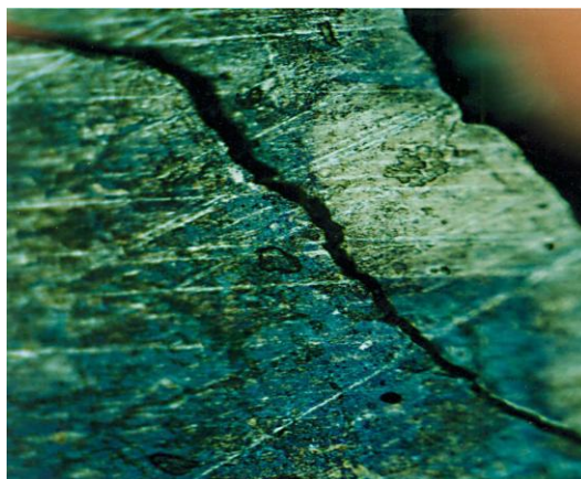
Obrázok 13. Únavové opotrebenie [5] Na povrchu sú patrné jamky únavového vydrolovania (pitting a mikropitting). Zväčšené 200 x.
