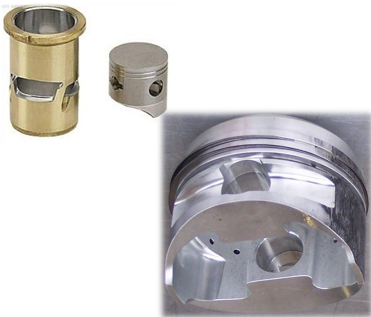
Obrázok 48. Ilustračný obrázok valca a piestov [10]
