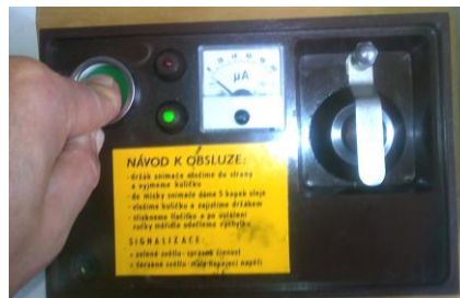
Kontrola prístroja pred meraním
