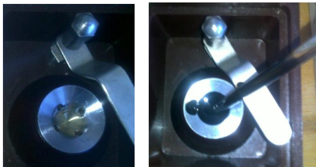
Vzorkovanie referenčného a použitého MO do prístroja
