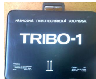
Meracia súprava, prípravok na meranie kinematickej viskozity
