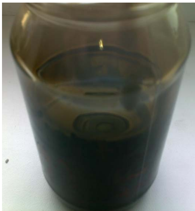
Kontrolovaná vzorka použitého MO 5W/30 s prípravkom Motor-Fit - PO ČISTENÍ
