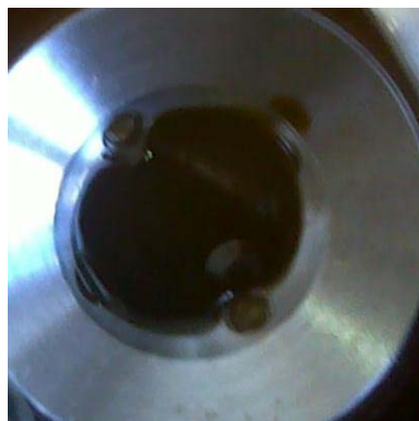
Nanesenie vzorky k elektródam
