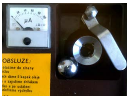
Nanesenie vzorky k elektródam
