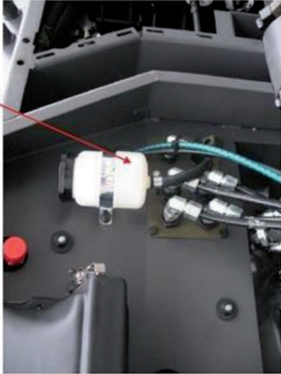
Obrázok č. 103 Náplň hydraulického okruhu ovládania spojky [30]
