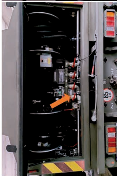
Obrázok č. 54 Zadná technologická skrini staršej generácie CN-5 a zadná bočná technologická skrini (lavá) [21]
