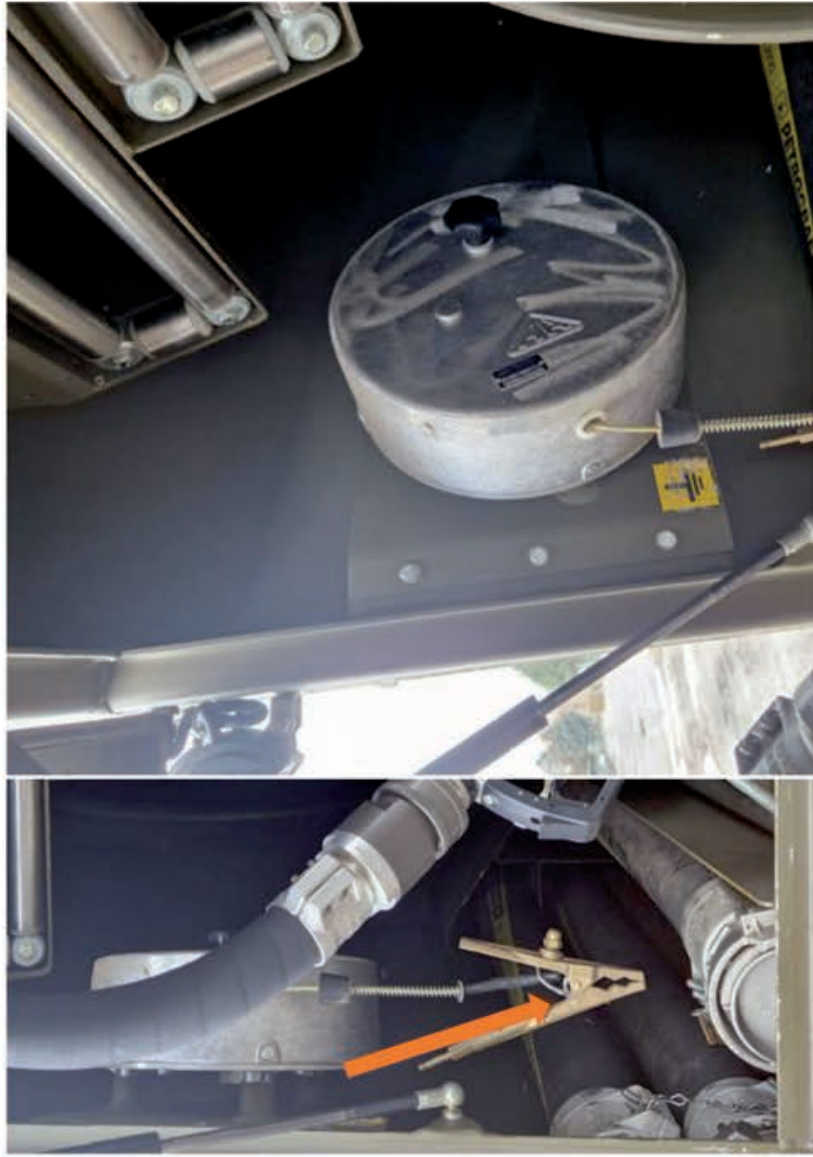
Obrázok č. 38 Uloženie uzemňovacieho lana a hadíc v schránke na hadice [21]
