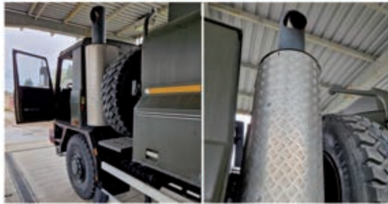
Obrázok č. 6 Inštalovaný tepelný štít na výfuku [21]
