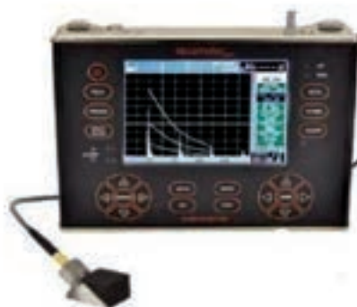
Obrázok č. 24 Ultrazvukový defektoskop FD800DL
