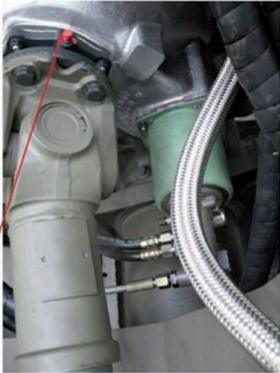
Obrázok č. 104 Ložisko spojkového hriadeľa [30]
