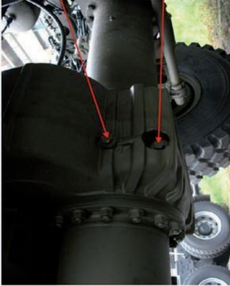
Obrázok č. 106 Olejová náplň prídavnej prevodovky [30]
