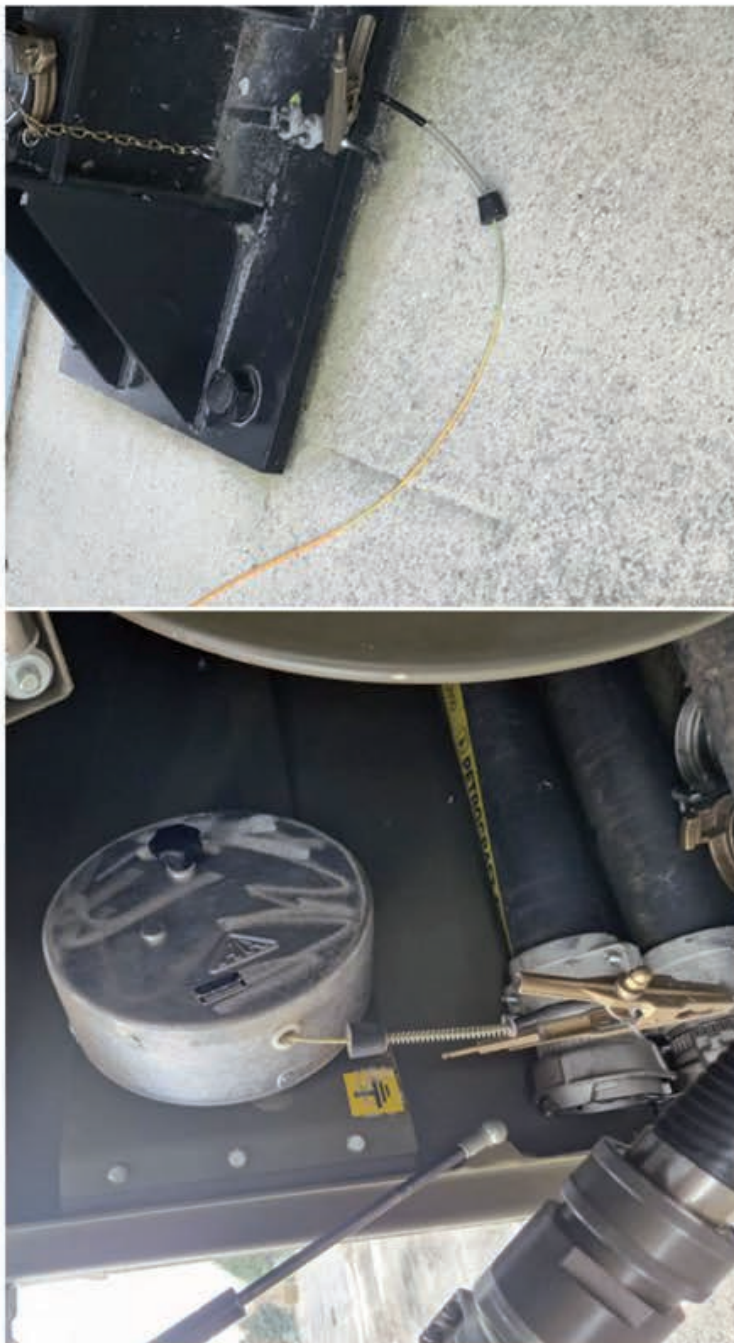
Obrázok č. 46 Umiestnenie lanka s kliešťami o uzemňovací zvod [21]
