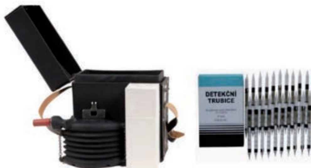
Obrázok č. 20 Detekčné trubice na stanovenie koncentrácie uhľovodíkových pár s nasávacím zariadením UNIVERZÁL vz.86 [15]
