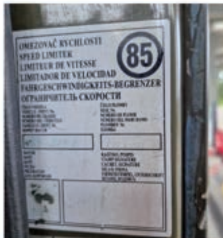
Obrázok č. 7 Označenie vybavenia vozidla obmedzovačom rýchlosti [21]
