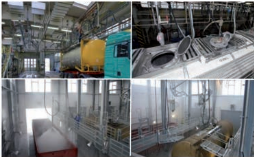
Obrázok č. 21 Čistenie vozidiel na linke spoločnosti URACA [16]
