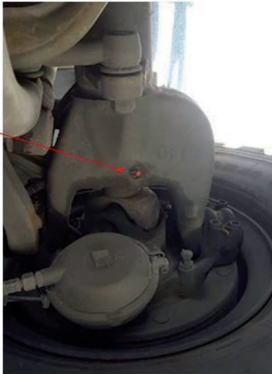
Obrázok č. 109 Ložiská uloženia kĺbových hriadeľov v polonápravách [30]
