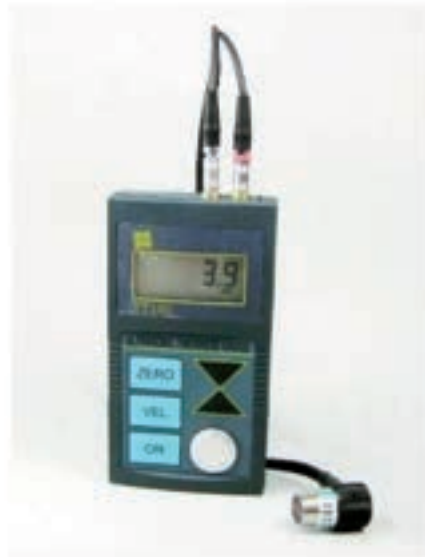
Obrázok č. 23 Ultrazvukový hrúbkomer DELTA TT100 [19]
