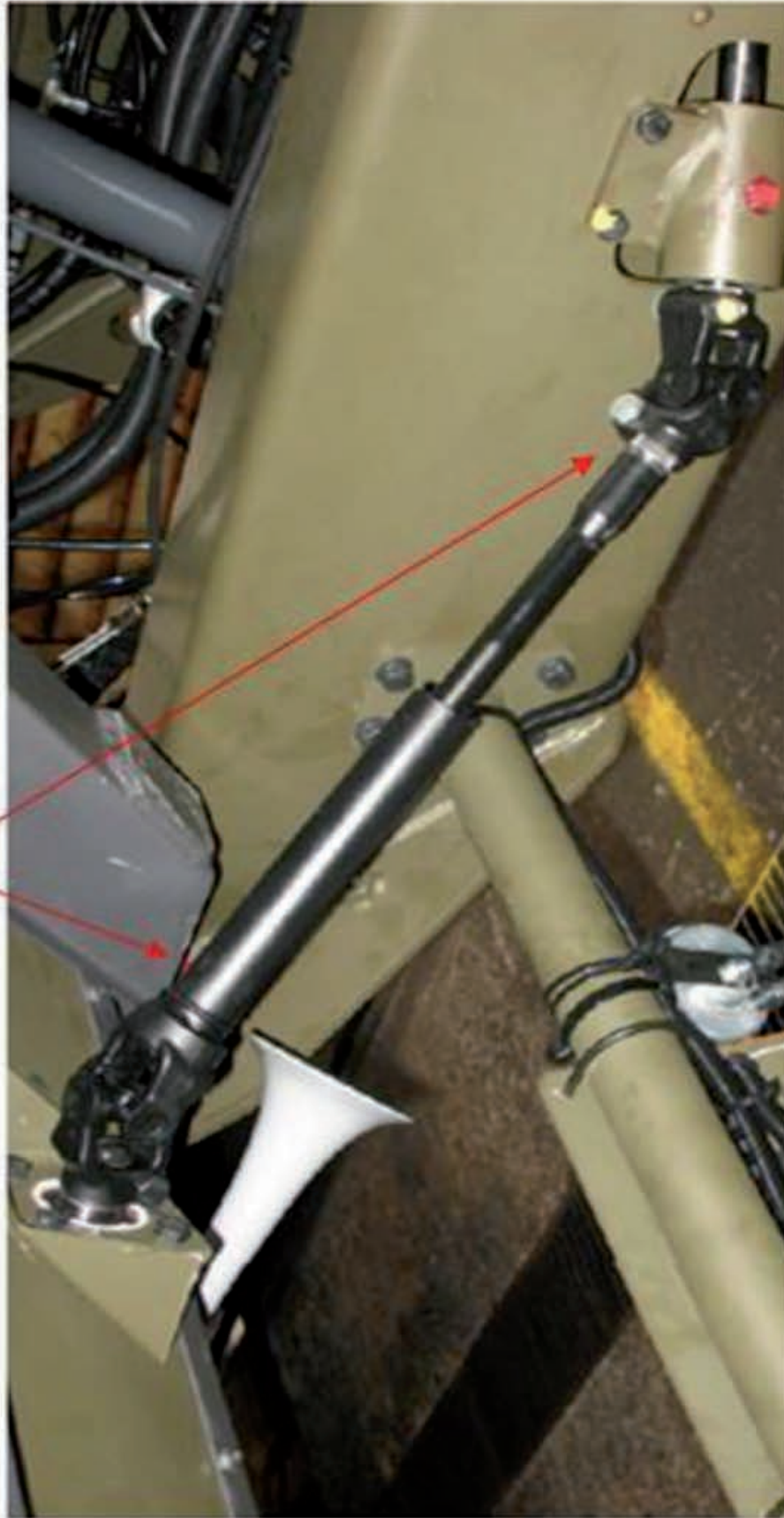
Obrázok č. 117 Teleskopické vreteno riadenia pod kabinou [30]
