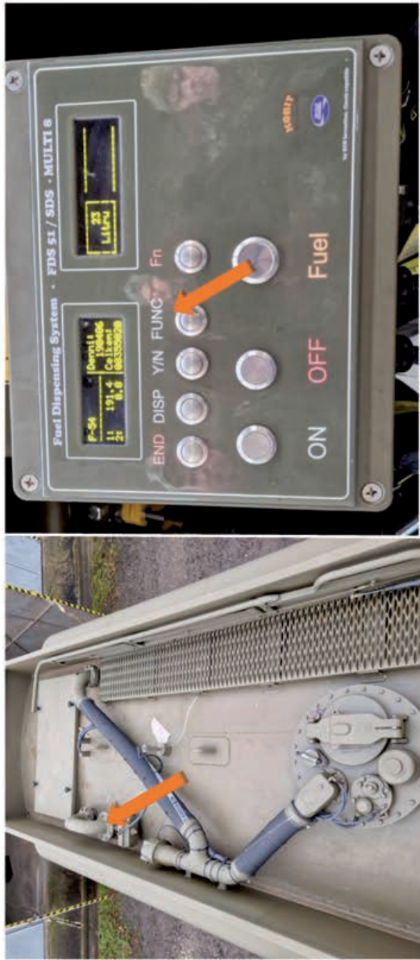
Obrázok č. 61 Voľba režimu externého plnenia a automatické otvorenie klapkového ventilu [21]
