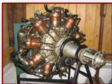
Obrázok 7, 8. Letecký motor - vľavo piestový-hviezdicový, v pravo piestový-radový inverzný <uzbek>
