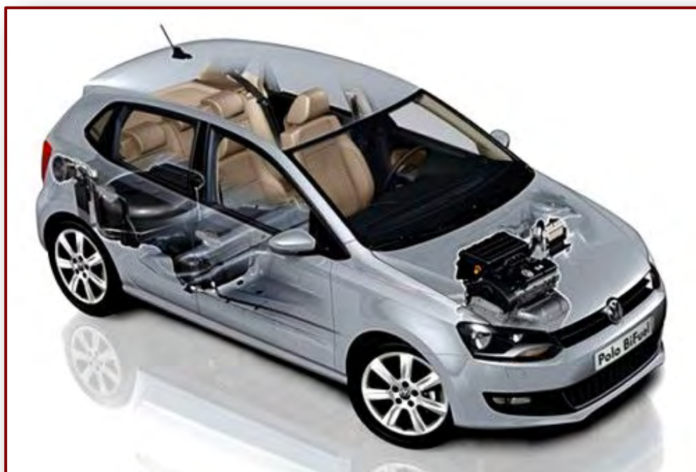
Obrázok 18. Systém Bi-Fuel Volkswagen Polo benzin+LPG <Megina>
