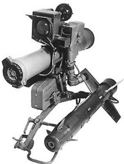
Obrázok 103 Odpaľovacie zariadenie 9P135M so strelou 9M113 Konkurz 253
